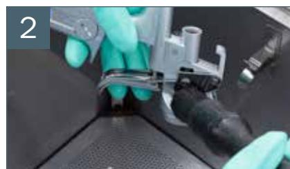
2 Reinigen des Pistolenkörpers
