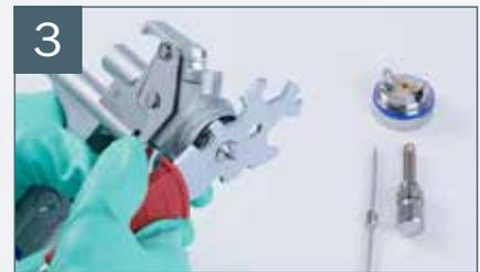
3 Ausschrauben der Farbdüse mit dem im Universal-Werkzeug integrierten Ringschlüssel
