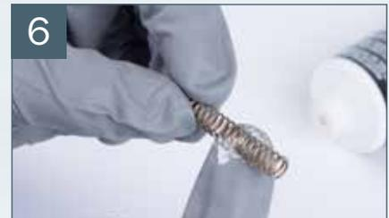
Einfetten\* und Einsetzen der Farbnadelfeder
