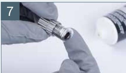
Gewinde der Materialmengenregulierschraube einfetten\*
