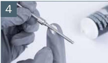
Einfetten\* der Farbnadel im Bereich der Nadeldichtung
