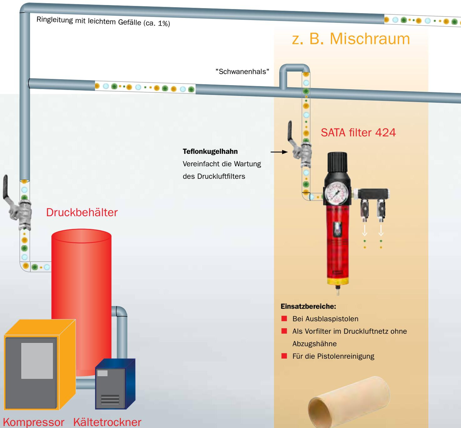
**Druckluft vom Kompressor kann durch verschiedene Substanzen verunreinigt sein:**
