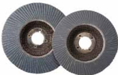
Posebna vrsta lamelnih diskov iz zrn cirkonijevega oksida na podlagi izjemno odpornih steklenih vlaken, primerni za vse vrste obdelav jeklene pločevine.
