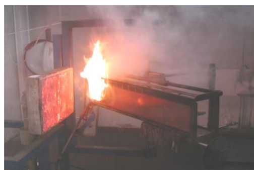
Test di resistenza al fuoco secondo la norma UNI 9796 (provino a sinistra = conforme, provino a destra= non in classe 1) Fire resistance test according to the UNI 9796 standard (specimen on the left = class 1 compliant, specimen on the right = non in class 1)
