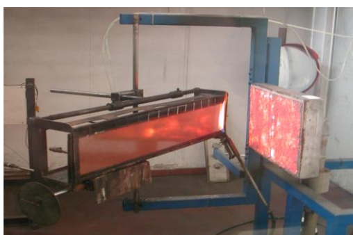
Test di resistenza al fuoco secondo la norma UNI 9796 (provino a sinistra = conforme, provino a destra= non in classe 1) Fire resistance test according to the UNI 9796 standard (specimen on the left = class 1 compliant, specimen on the right = non in class 1)
