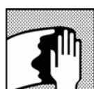
Čiščenje površine; odstranite vsa onesnaženja s površine pred nanosom Autosurfacer Rapid ob uporabi primerenega čistilca površine. Kjer je izpostavljen bodyfiller, prepračite stik z vodo (npr. Razmaščevalec na vodni osnovi).
