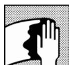
Čiščenje površine; pred brušenjem odstranite vsa onesnaženja s površine ob uporabi primerenega čistilca površine.
